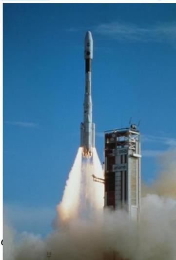
Il existe de nombreuses combinaisons de propergols ayant fait leurs preuves et conduisant à toute une variété de propulsion répondant aux différents besoins : libération de la pesanteur terrestre, vol stationnaire... Ainsi la réaction entre le peroxyde d'azote ( $N_2O_4$  noté NTO) et la 1,1-diméthylhydrazine liquide ( $NH_2-N(CH_3)_2$ , notée UDMH) est cruciale pour la propulsion des fusées hors de l'atmosphère terrestre et a notamment été utilisée dans le moteur Viking 4 de la fusée Ariane 4.
